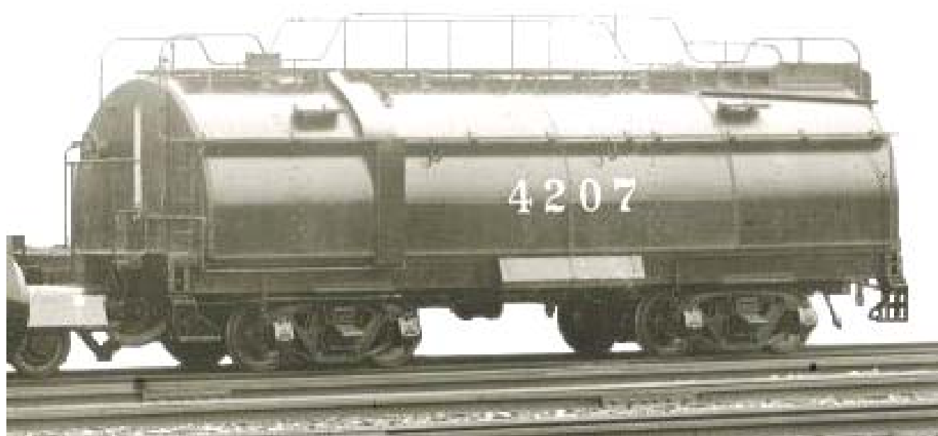
Fig. 720 – T nder Whale Back de dos bogies de dos ejes, de las locomotoras clase MM-2 del Southern Pacific Railroad, construido en 1911 por Baldwin Locomotive Works. Capacidad 38 m 3 de agua y 12 m 3 de petr leo.
