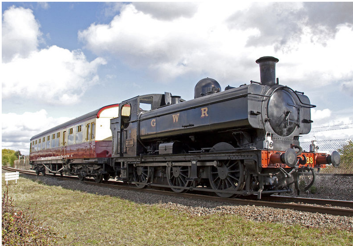
Fig. 753 – Locomotora-ténder del Great Western Railway serie 5700, N° 4612, rodado 0-6-0. Tanques alforja longitud total. Capacidad 5,5 m 3 de agua y 1 tonelada de carbón.
