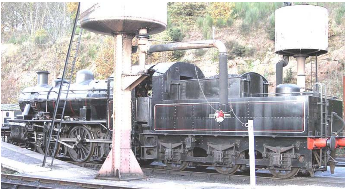
Fig. 710 – Ténder de tres ejes correspondiente a la locomotora 46443, clase Ivatt, de los Ferrocarriles Británicos, construida en Horwich Works en 1948. Capacidad 16m 3 de agua y 4,1 t de carbón. Este ténder posee un cerramiento que le permite a la locomotora operar igualmente en ambos sentidos.
