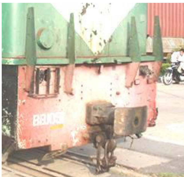
Fig. 736 – Enganche de tope central y cadena
