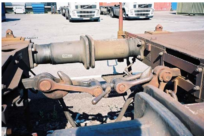
Fig. 732 – Enganche de topes y cadena, en posición de máximo ajuste.
