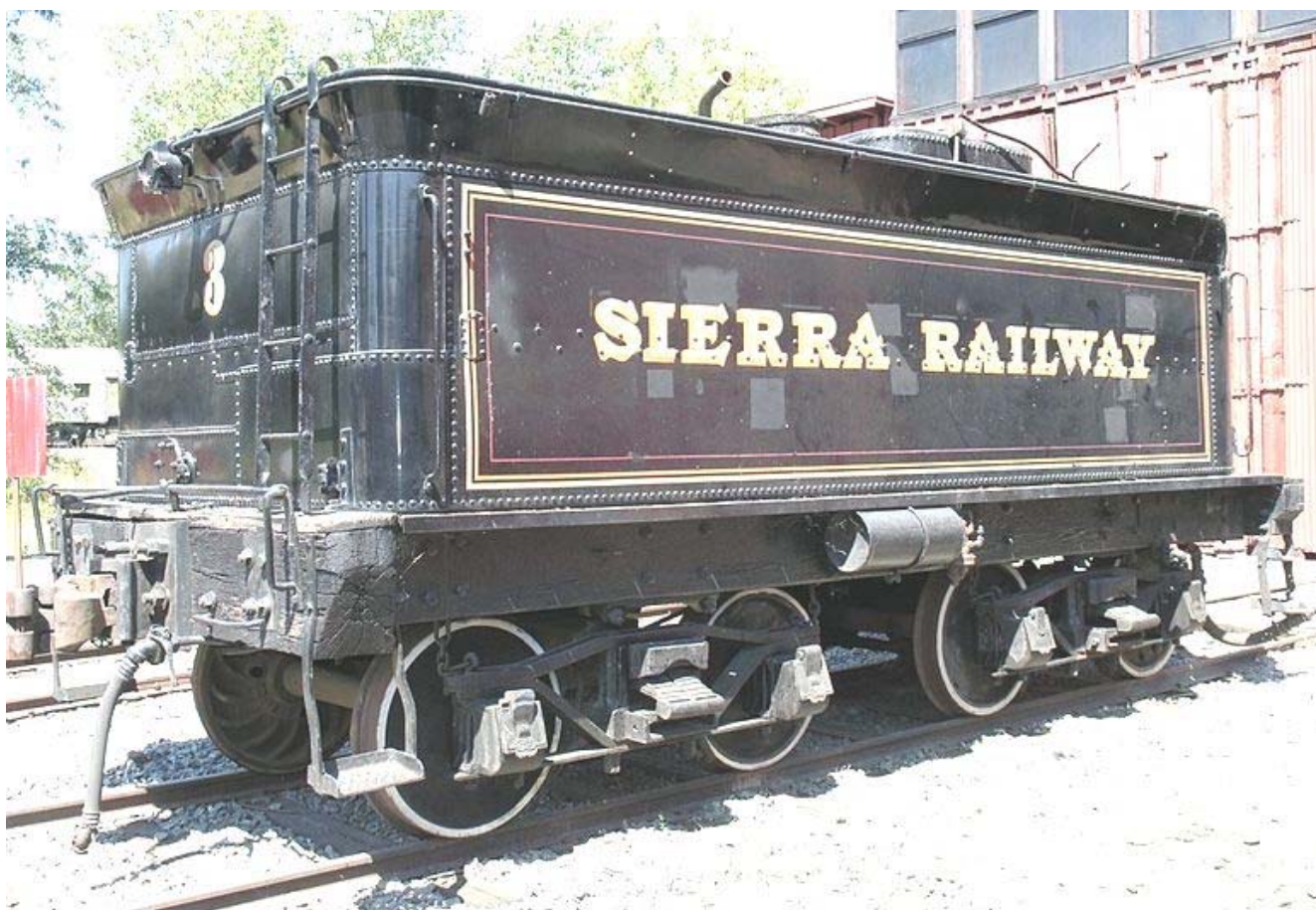
Fig. 712 – T nder de dos boguies Diamond de dos ejes, fabricados de planchuela, resortes de l minas, de la locomotora N  3 del Sierra Railroad, fabricado por Rogers en 1891. Capacidad 11,2 m 3 de agua y 4,5 t de carb n
