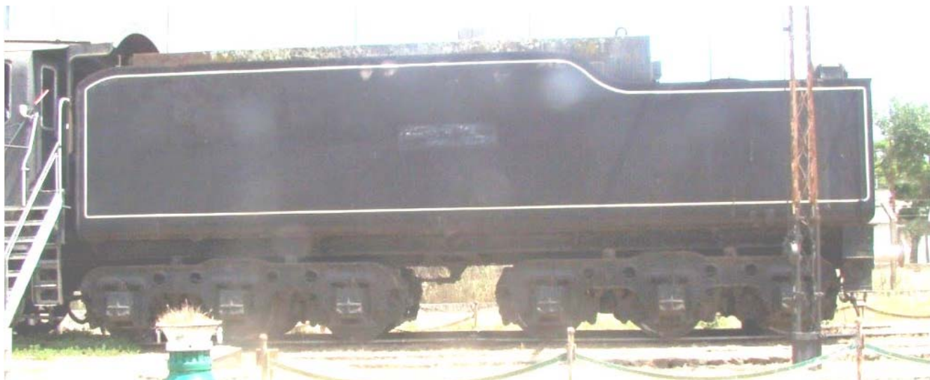
Fig. 715 – T nder de dos bogies de tres ejes, de locomotora clase 12L del Ferrocarril General Roca, construido por Vulcan Foundry en 1950, original para quemar petr leo. Capacidad 40,9 m 3 de agua, 11,6 t de combustible.
