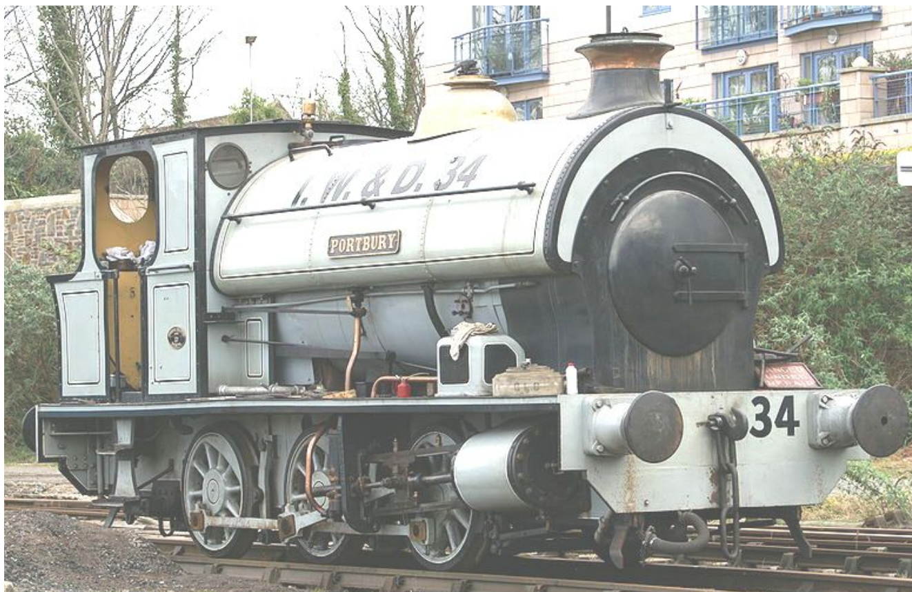
Fig. 755 – Locomotora-ténder del Portbury Briston Harbour Railway, rodado 0-6-0, tanque de agua “a caballo”.
