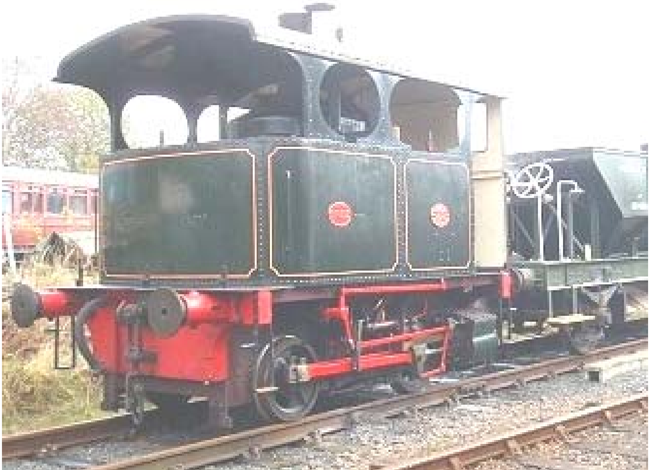
Fig. 758 – Locomotora-ténder 0-4-0 de caldera vertical, Construida en Bélgica en 1920 y utilizada en Bruselas Gas Works hasta 1967.
