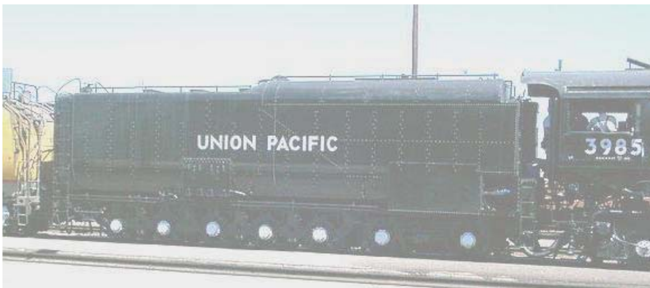
Fig. 717 – T nder de cinco ejes r gidos y un bogie delantero, llamado Centipede (ciempi s), de las locomotoras Challenger del Union Pacific, construido en 1943 por American Locomotive Co. Capacidad 94,6 m 3 de agua y 22,5 m 3 de petr leo.
