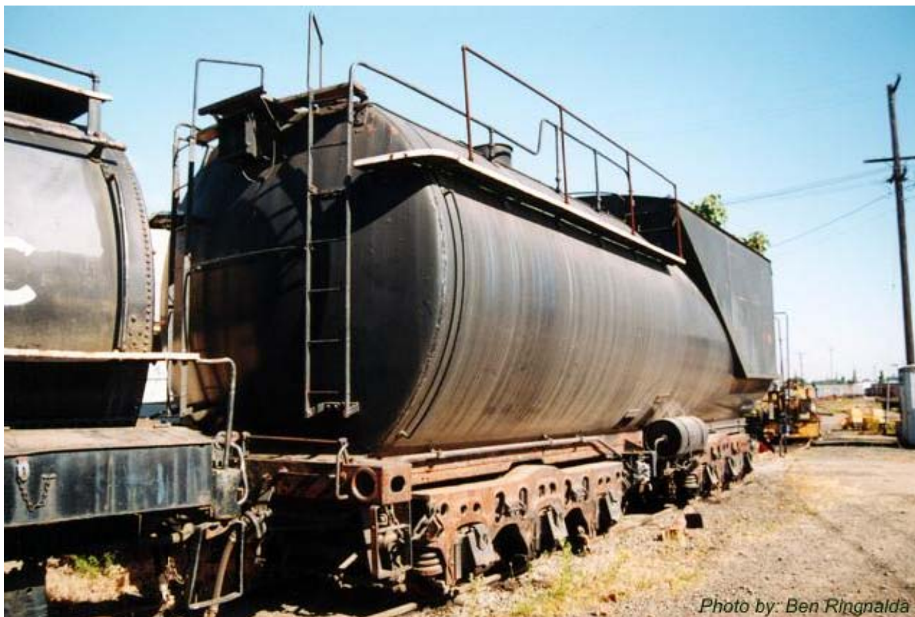
Fig. 719 – T nder Vanderbilt de dos bogies de tres ejes, de las locomotoras clase S-2 del Great Northern Railway, construido en 1930 por Baldwin Locomotive Works. Capacidad 82,8 m 3 de agua y 21,9 m 3 de petr leo.
