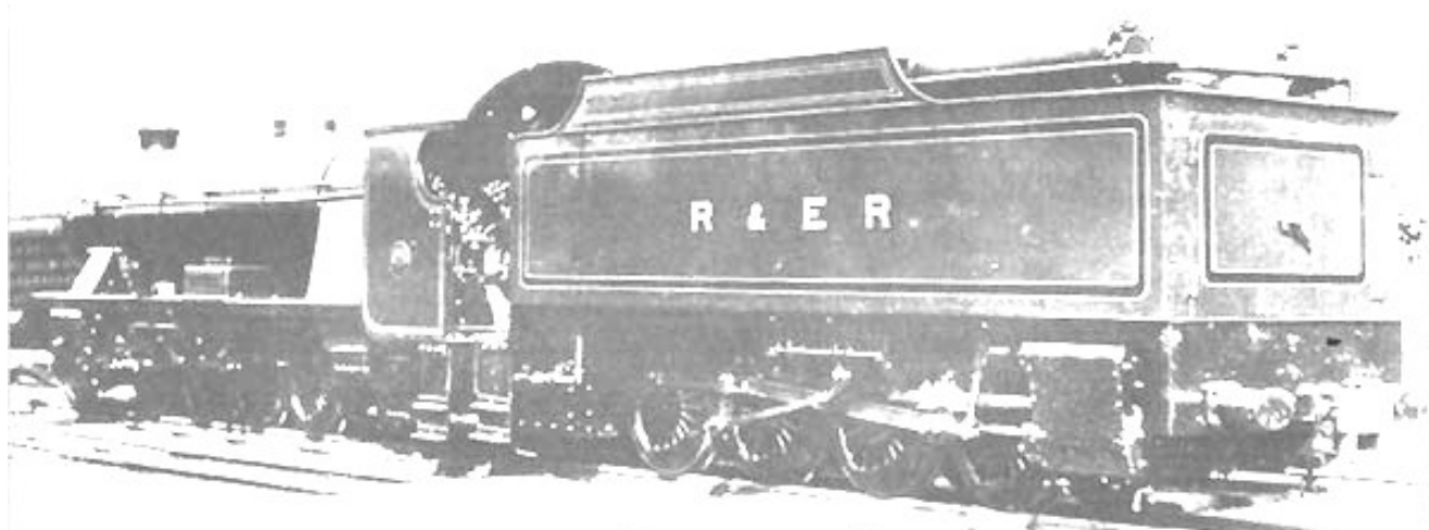
Fig. 721 – Ténder de cuatro ejes motrices, de la locomotora River Mite, del R. & E. R., construido en 1927.
