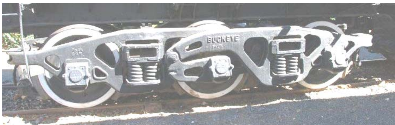
Fig. 716 – Bogie de tres ejes tipo Buckeye ampliamente utilizado en t nder.
