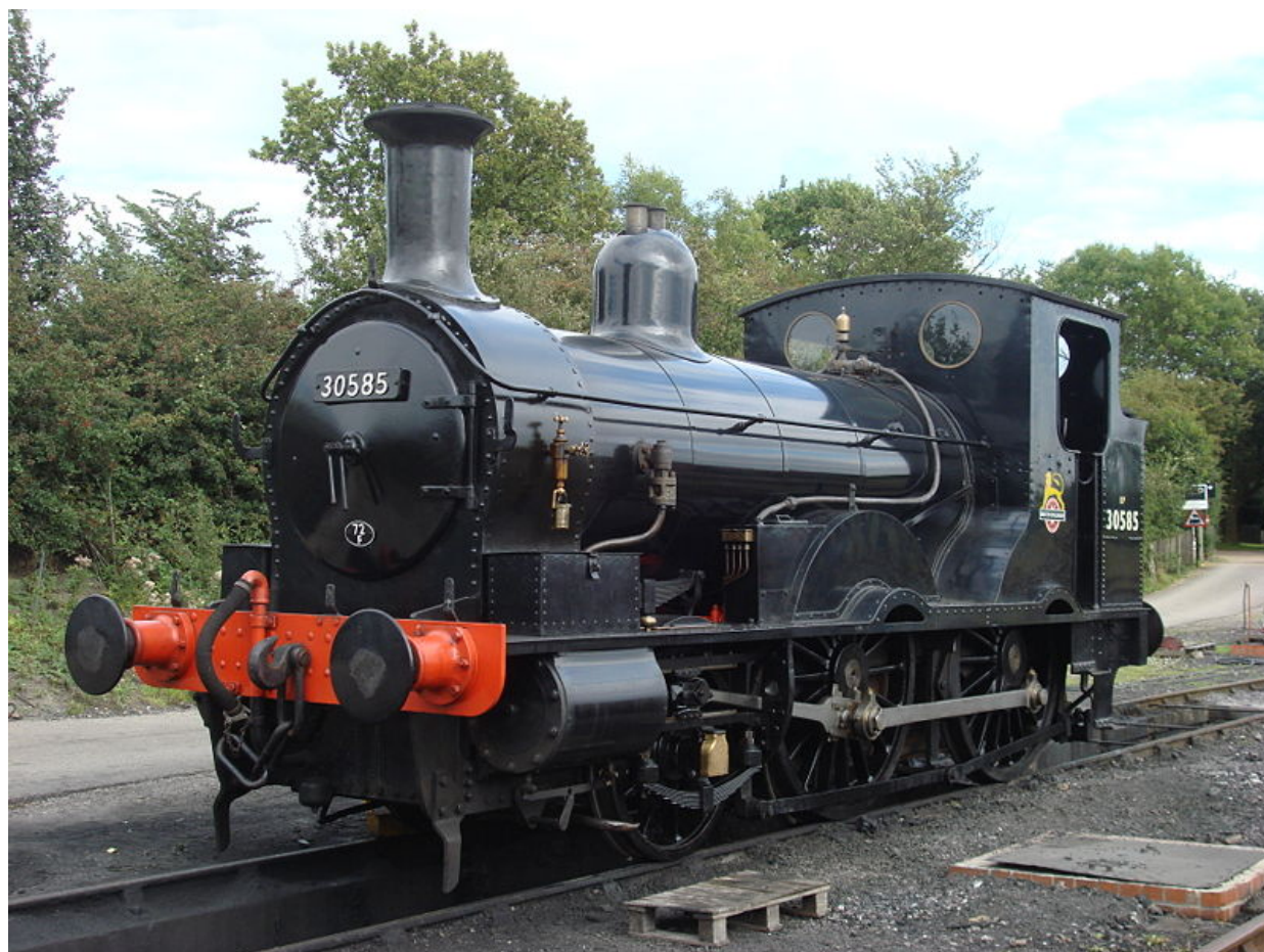
Fig. 754 – Locomotora-ténder del London & South Western Railway, rodado 4-4-2T, tanque de agua “de pozo”, construida por Beyer Peacock en 1874. Capacidad 2,5 m 3 de agua y 1 tonelada de carbón.
