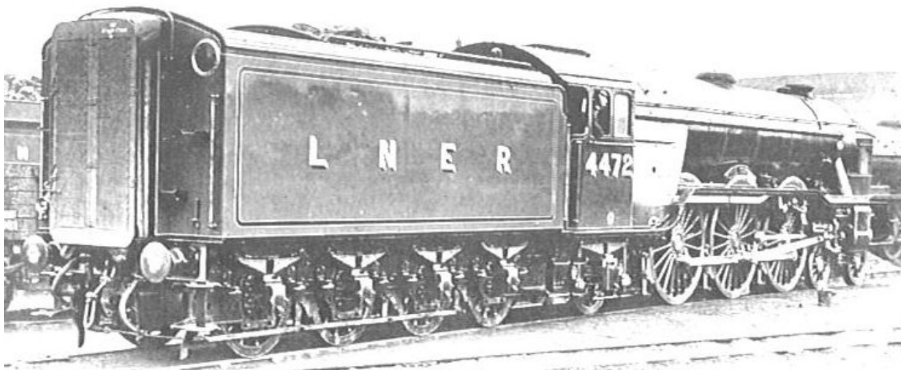
Fig. 711 – T nder de cuatro ejes r gidos del London & North Eastern Railway, construido en Doncaster Works en 1923, para las locomotoras clase A3. Capacidad 22 m 3 de agua y 9 t de carb n. Como en el caso de las locomotoras, dos ejes ten an la posibilidad de desplazamiento transversal. Incluye una comunicaci n de la dotaci n con el tren, a trav s de un t nel de 1,45 m de alto y 0,45 m de ancho, ubicado sobre el lado derecho del t nder, que permit a el relevo del personal de la locomotora sin detenerse, en el recorrido desde Londres hasta Edimburgo (631 km sin paradas).
