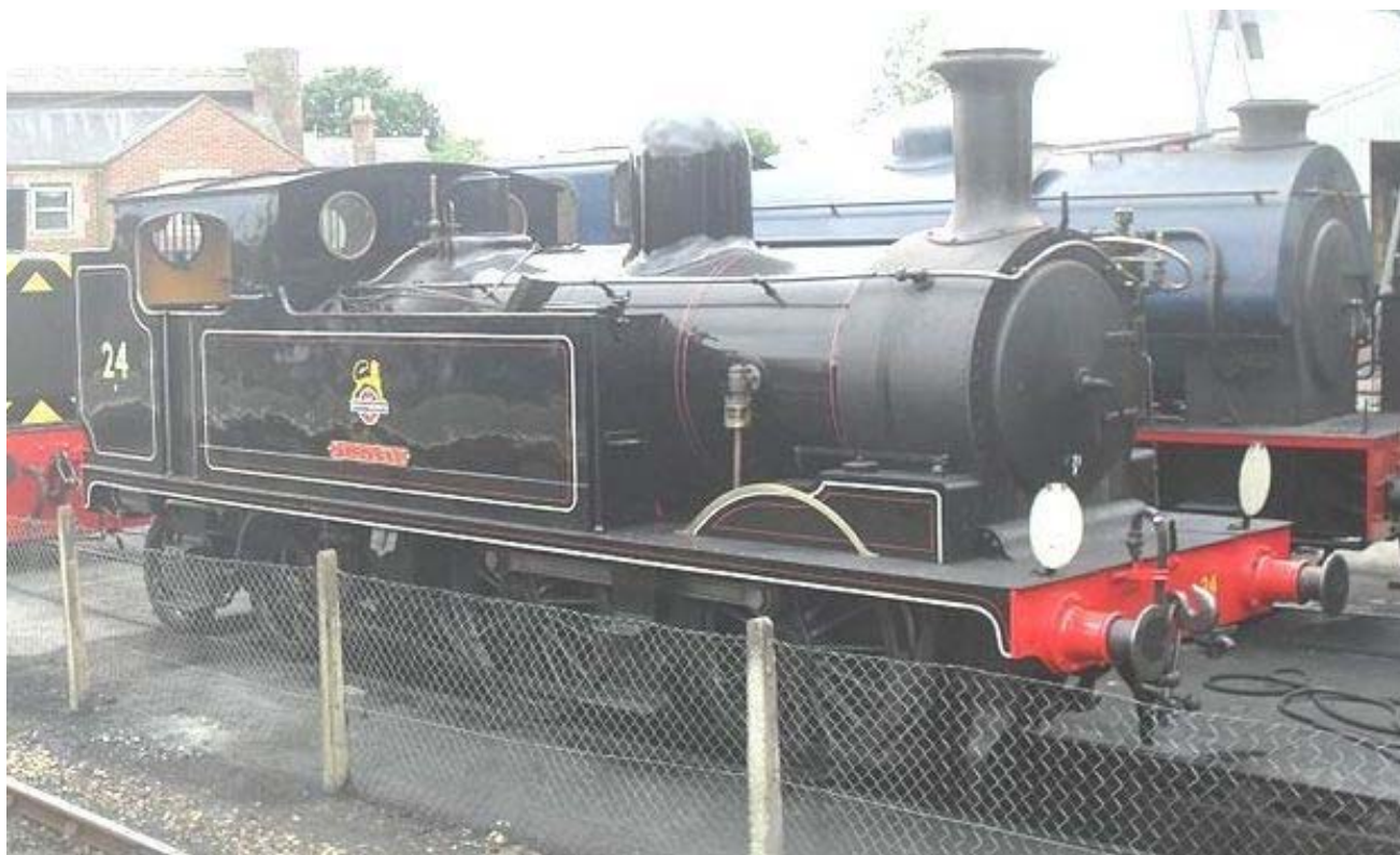
Fig. 756 – Locomotora W24Calbourne, rodado 0-4-4T, del London & South Western Railway, construida por Nine Elms Locomotive Works, en 1981. Tanques laterales. Capacidad 3,6 m 3 de agua y 3,3 toneladas de carbón.
