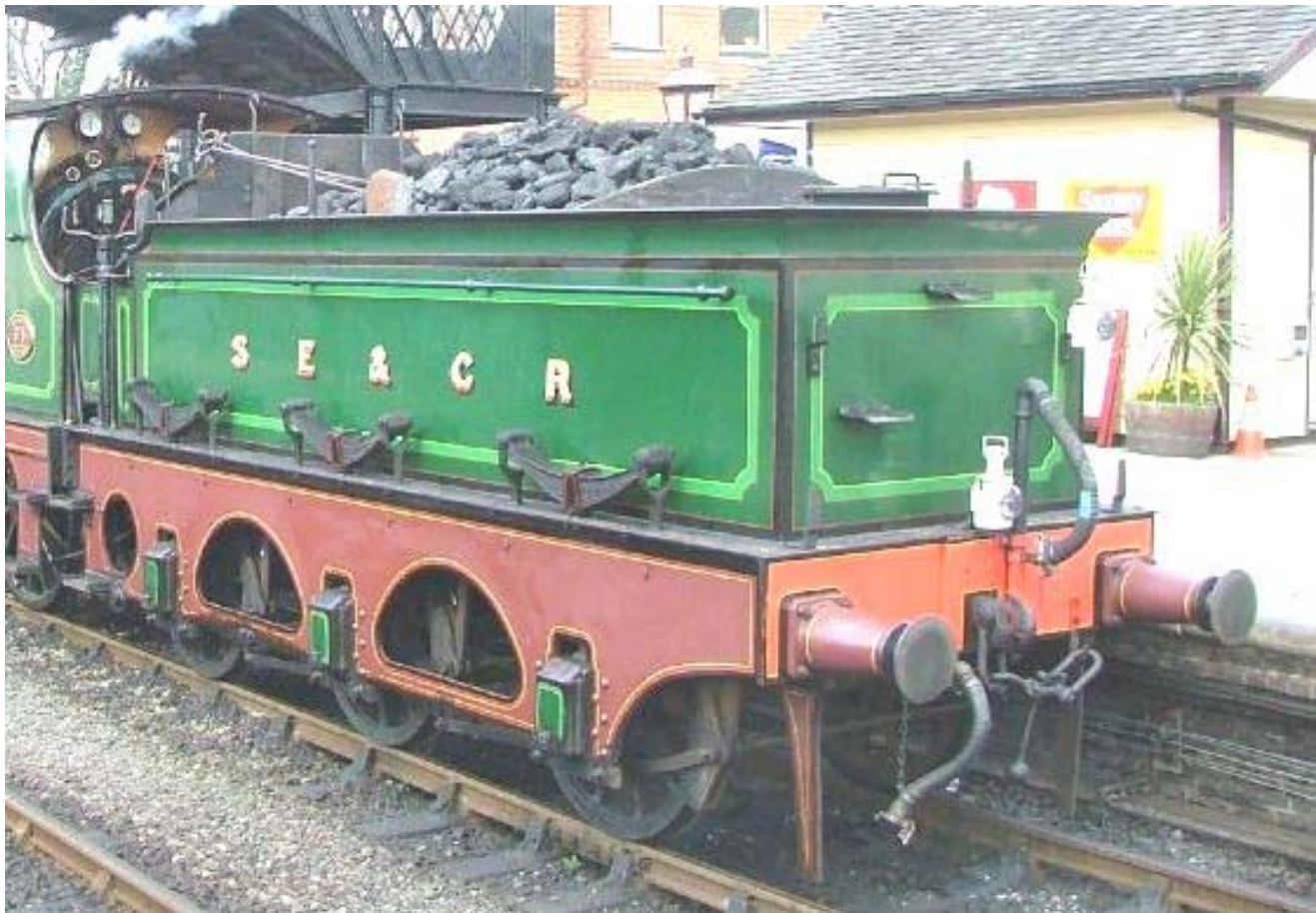
Fig. 709 – Ténder de tres ejes correspondiente a la locomotora N° 65 del South Eastern and Chatham Railway, construida en Ashford en 1896. Capacidad 9 m 3 de agua y 2,8 t de carbón. Ver detalles de la suspensión.
