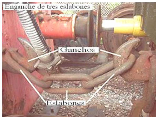
Fig. 733 – Enganche con cadena de tres eslabones
