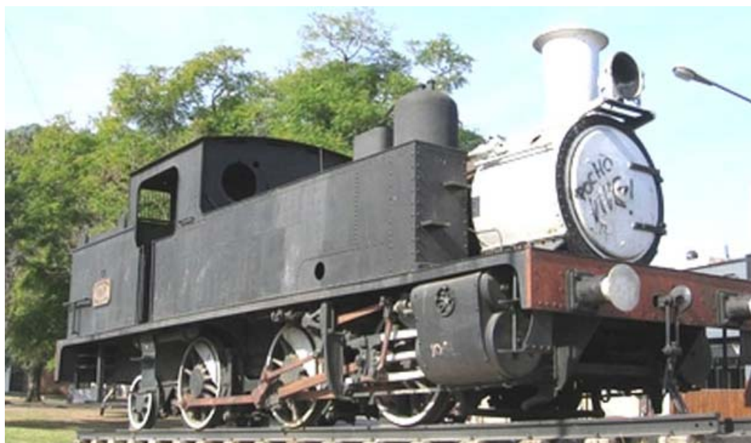
Fig. 677 – Locomotora 0-6-2T del Ferrocarril Central Argentino, clase SS5, construida por North British en 1928. Hogar entre los ejes acoplados.
