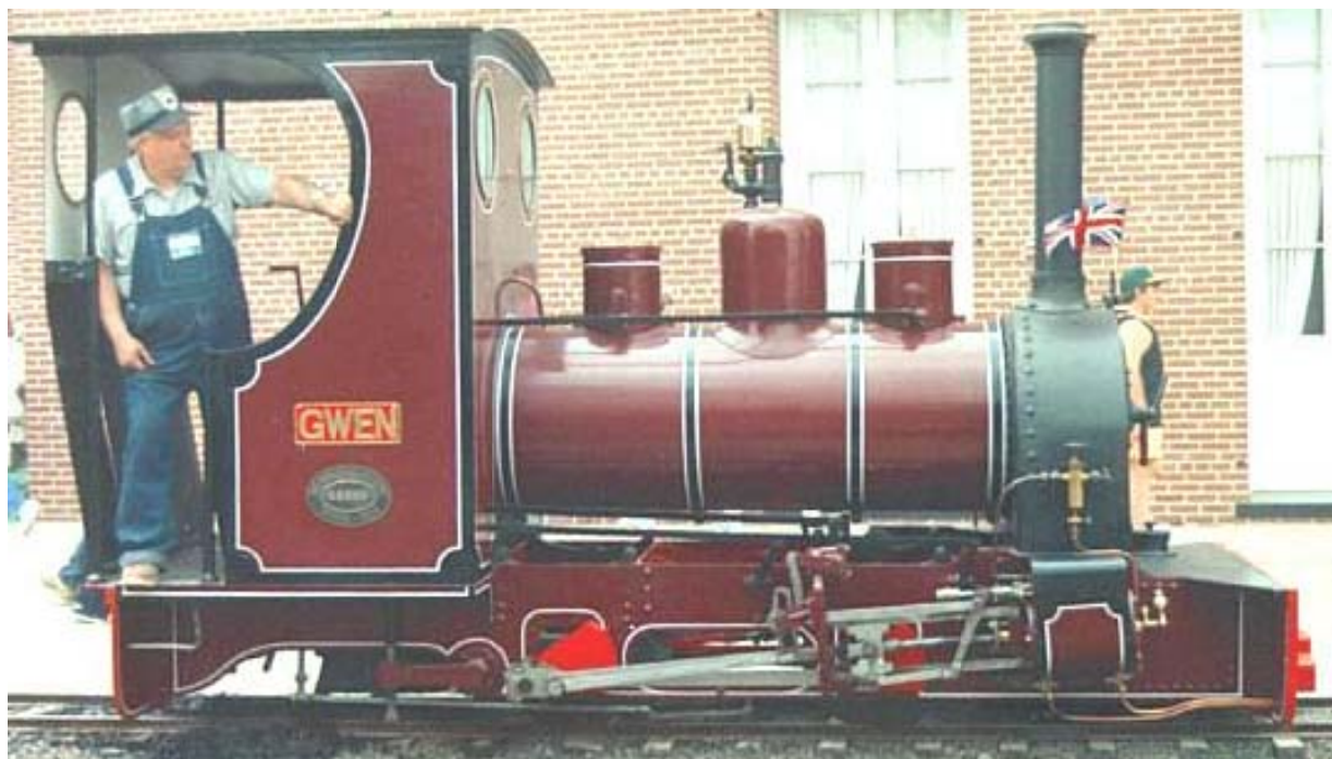
Fig. 669 – Locomotora 0-4-0 Gwen, fabricada por Hunslet (Leeds) en 1920, trocha de 18" (457 mm). Preservada en Northbridge, California
