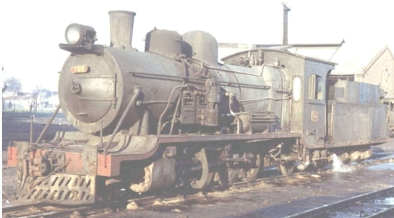
Fig. 686 – Locomotora 2-8-2, clase C10 del Ferrocarril Central Norte, construida por North British en 1911. Hogar detrás del cuarto eje.
