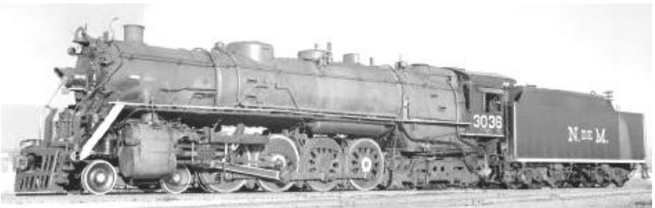
Fig. 689 – Locomotora 4-8-4, clase QR-1, de Ferrocarriles Nacionales de México, construida por Baldwin Locomotive Works (BLW), en 1946.
