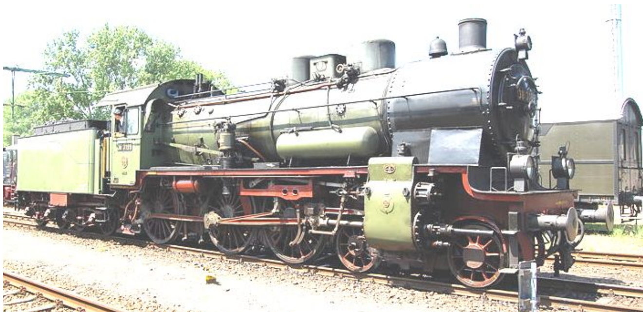
Fig. 680. – Locomotora prusiana P8 rodado 4-6-0, fabricada entre 1906 y 1928 (totalizando más de 3.800 unidades)
