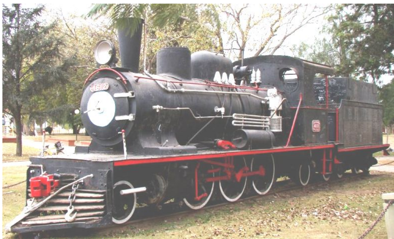
Fig. 679 – Locomotora 2-6-2 clase C10 del Ferrocarril Provincial de Santa Fe, preservada en Arroyito. Foto de R.Respini.
