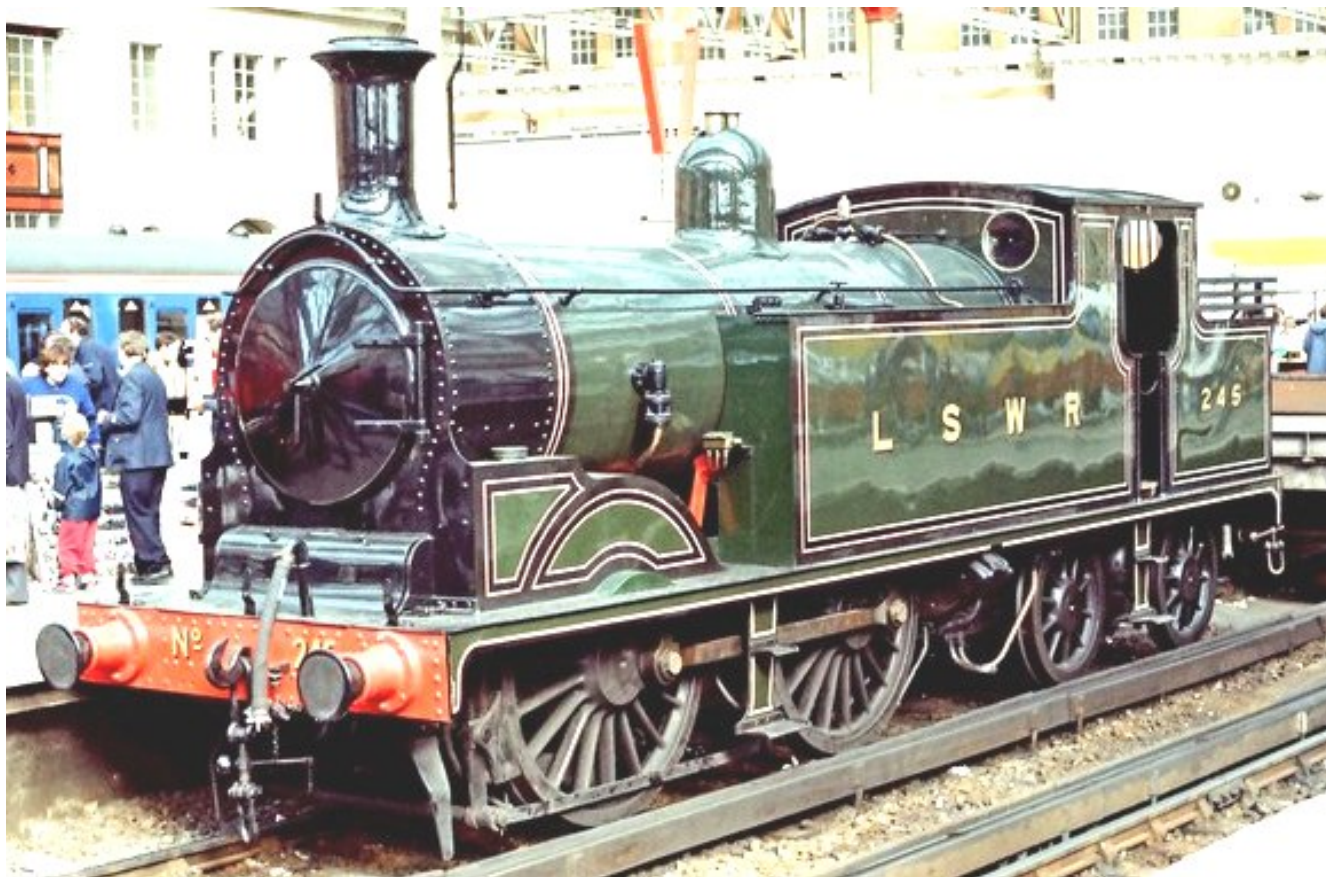
Fig. 672 – Locomotora 0-4-4T del London & South Western Railway, construidas por Nine Elms Locomotive Works entre 1897 y 1911. Hogar detrás de los ejes acoplados.
