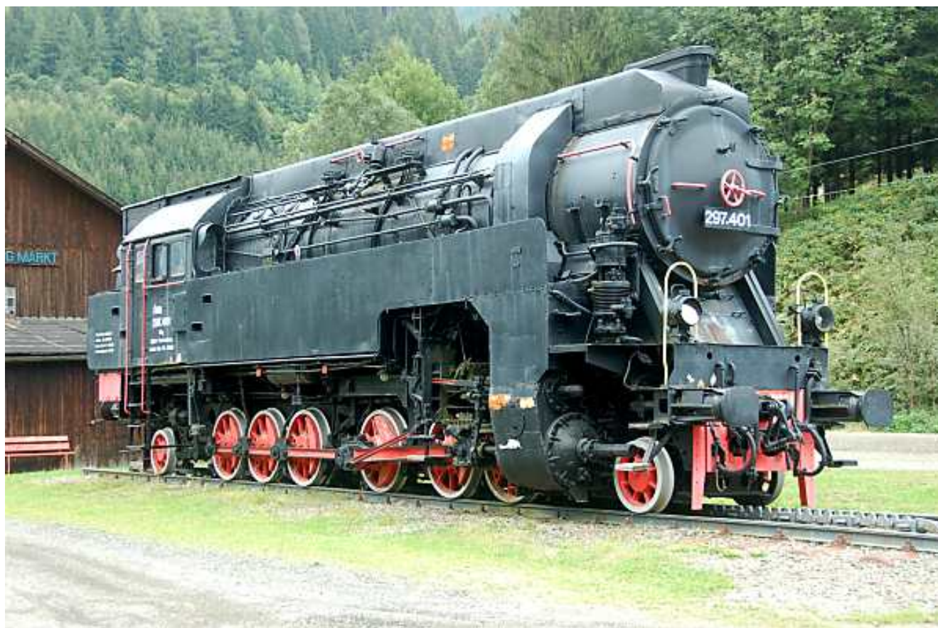
Fig. 698 – Locomotora 2-12-2T, de adhesion y cremallera, construida en 1941 para el Ferrocarril Austríaco Erzbergbahn
