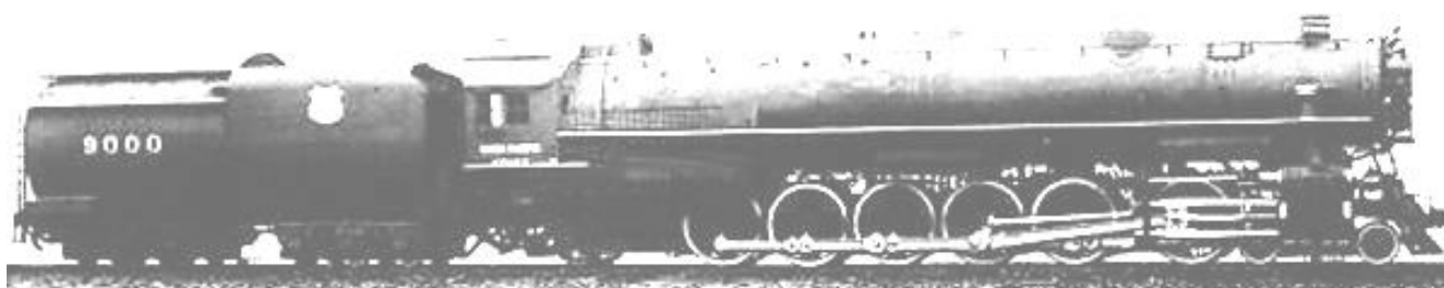
Fig. 700 – Locomotora 4-12-2, clase 9000 del Union Pacific R.R., del que toma su denominación, construidas entre 1926 y 1930 por American Locomotive Co.
