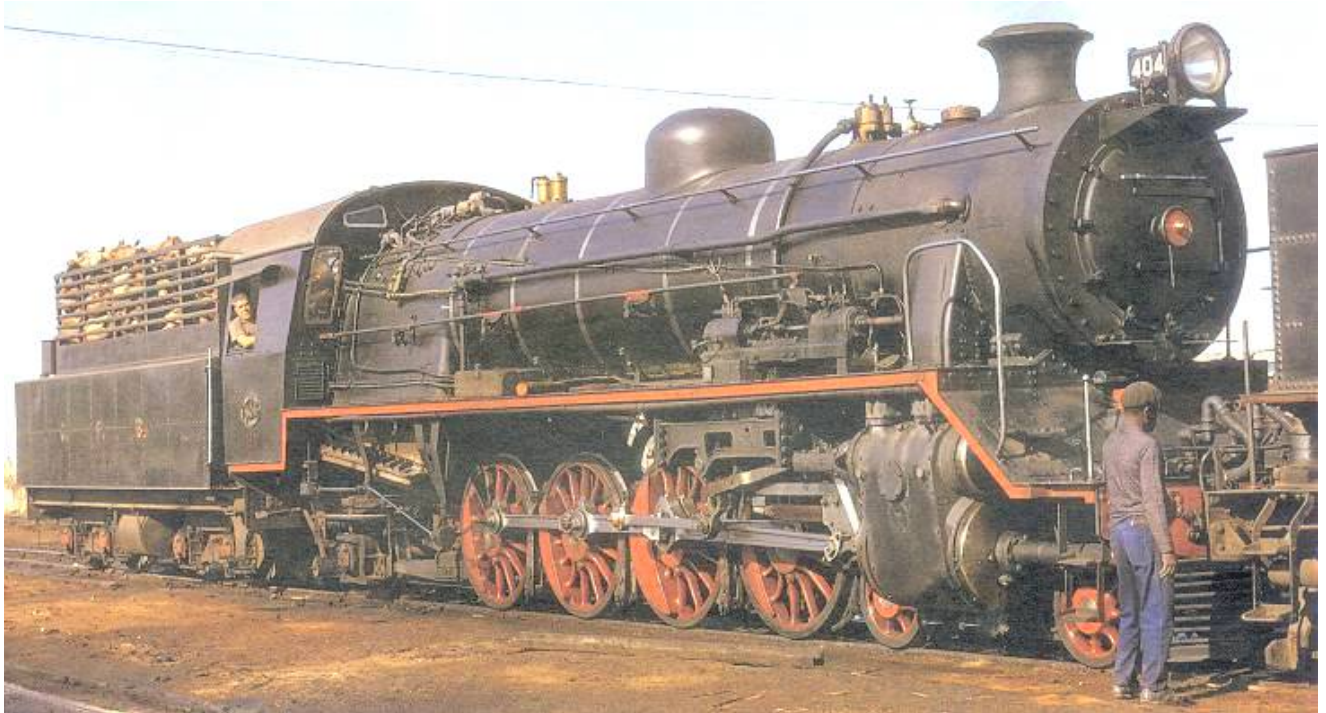
Fig. 688 – Locomotora serie 11, 4-8-2, del Caminho de Ferro de Benguela (CFB), en Angola. Construida por North British en 1951.
