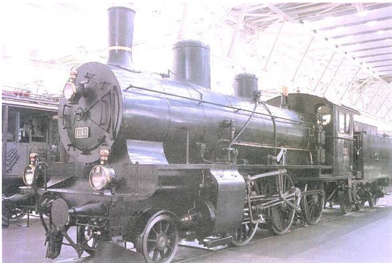
Fig. 678 – Locomotora 2-6-0 de los ferrocarriles suizos (SBB), fabricada en 1904 por SLM.
