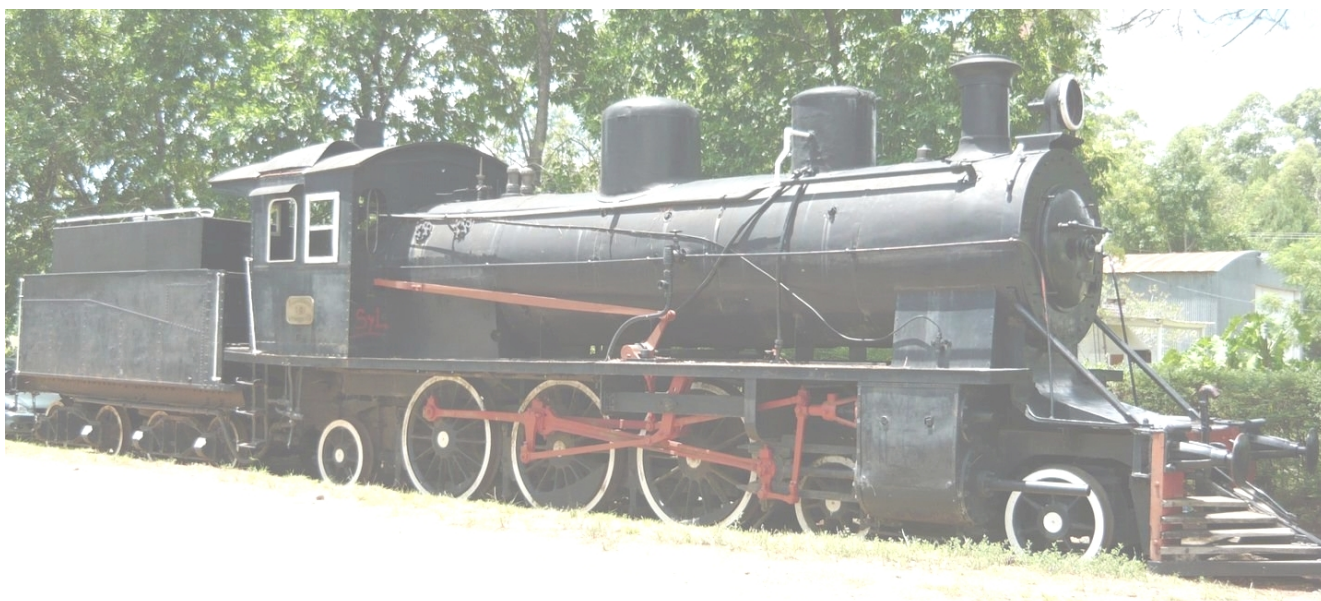
Fig. 681 – Locomotora 4-6-2 del Ferrocarril Central de Buenos Aires, construida por Maffei en 1911. (Foto Claudio Espinosa.)
