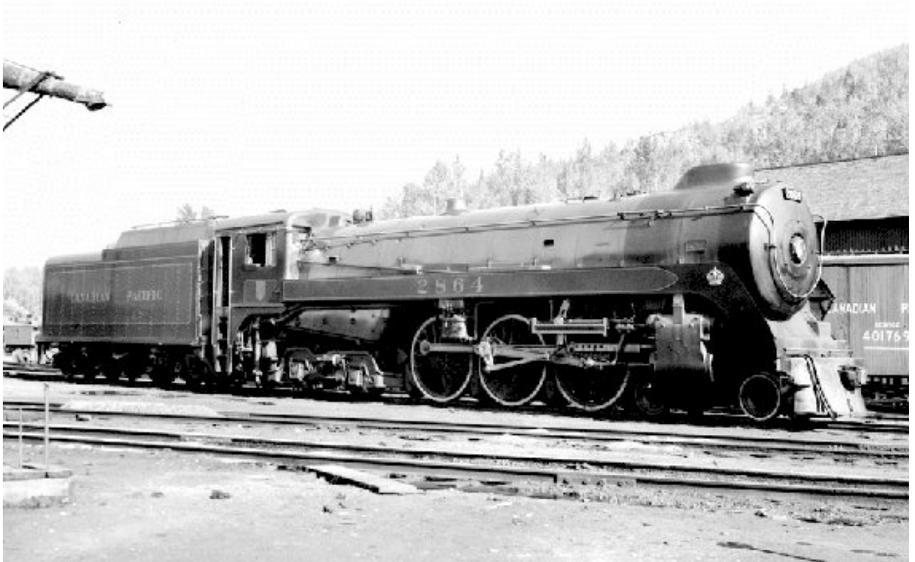
Fig. 665 – Locomotora canadiense Royal Hudson, con cabina totalmente cerrada.
