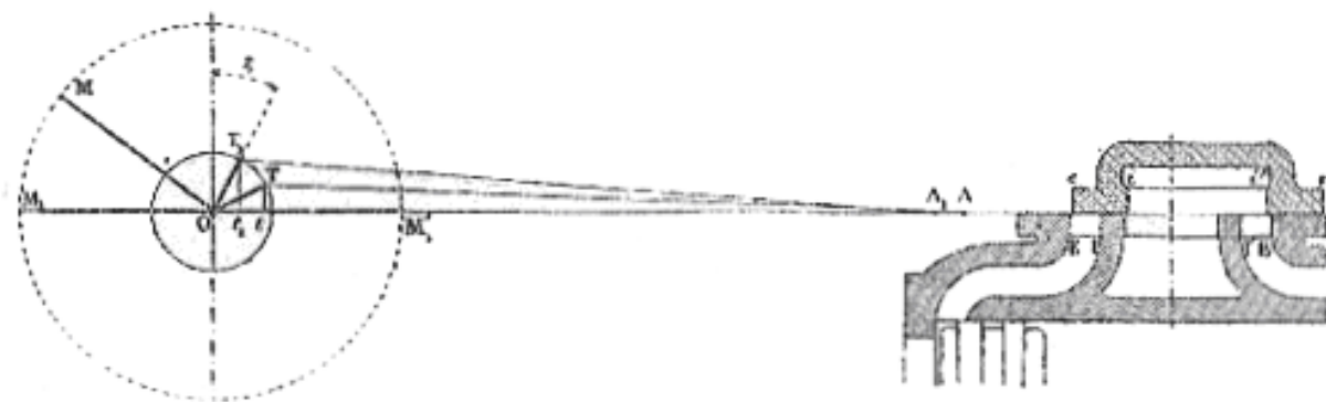
Fig. 409 – Accionamiento de la corredera por un excéntrico (se modificó en cuanto a la figura, por una rotación de un ángulo recto, el corte de la corredera y sus lumbreras, para volverlas visibles).
