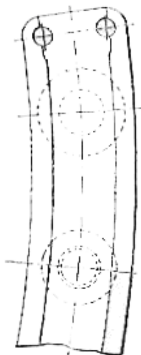
Fig. 422 – Brazos de sector Stephenson, que muestran la entrada sobre la cual se montan los espaciadores, para permitir la rectificación del taco, sin cambiarlos.
