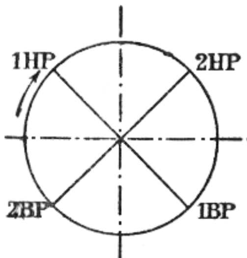
Fig. 506 – Manivelas de compound de cuatro cilindros, en mala posición de arranque.
