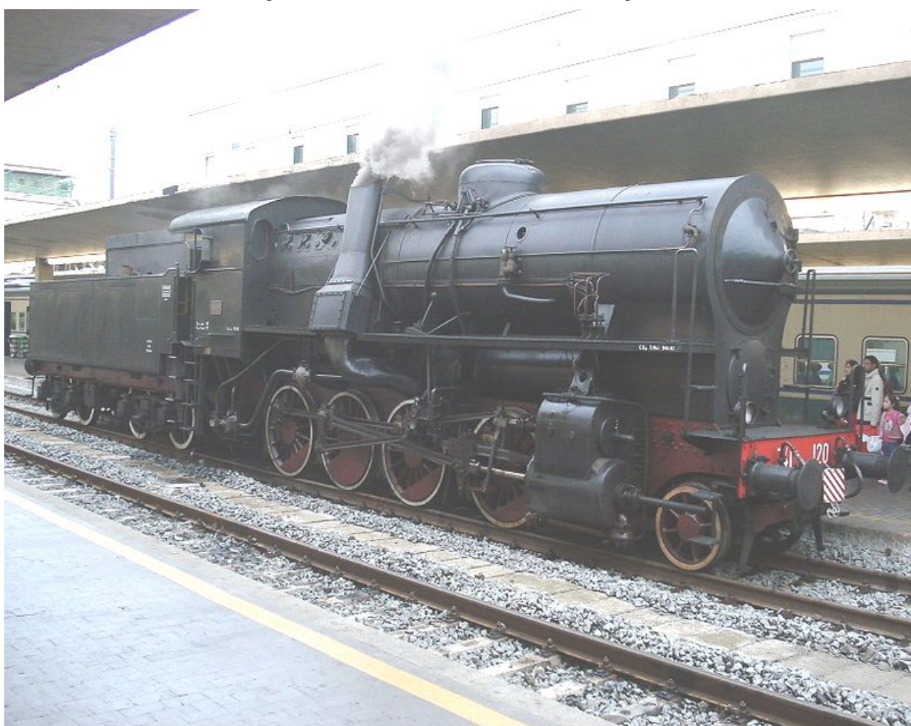
Fig. 264 – Locomotora de los Ferrocarriles Italianos, equipada con calentador Franco-Crosti
