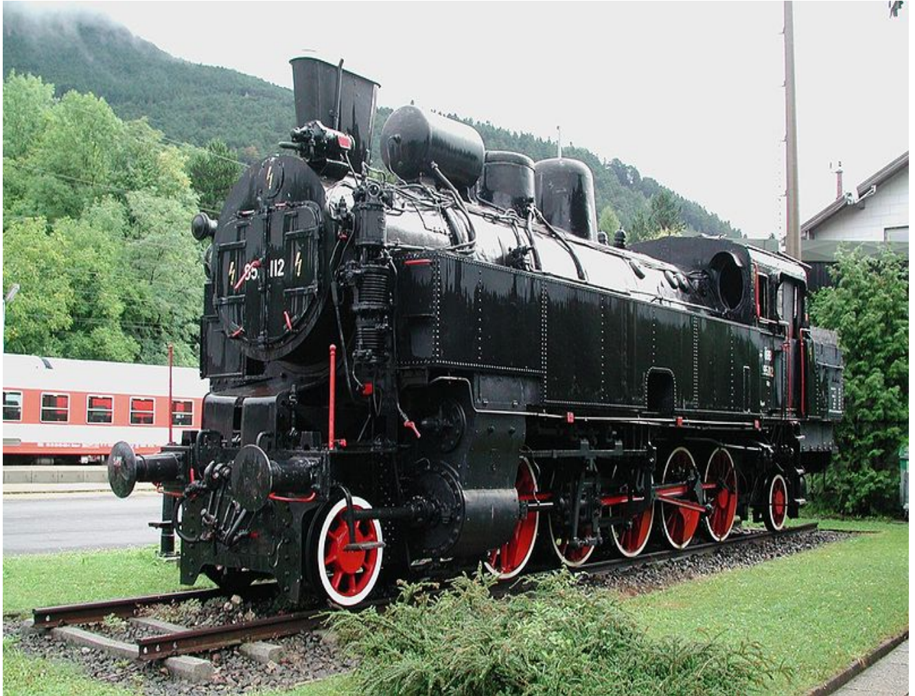
Fig. 215 – La última sobreviviente de la clase 95 del ÖBB (Ferrocarriles austríacos), ex clase 82 del Südbahn (Ferrocarril del Sud), expuesta en la estación Payerbach-Reichenau del Ferrocarril de Semmering. Estas locomotoras fueron principalmente empleadas para empuje y doble tracción de trenes pesados.
