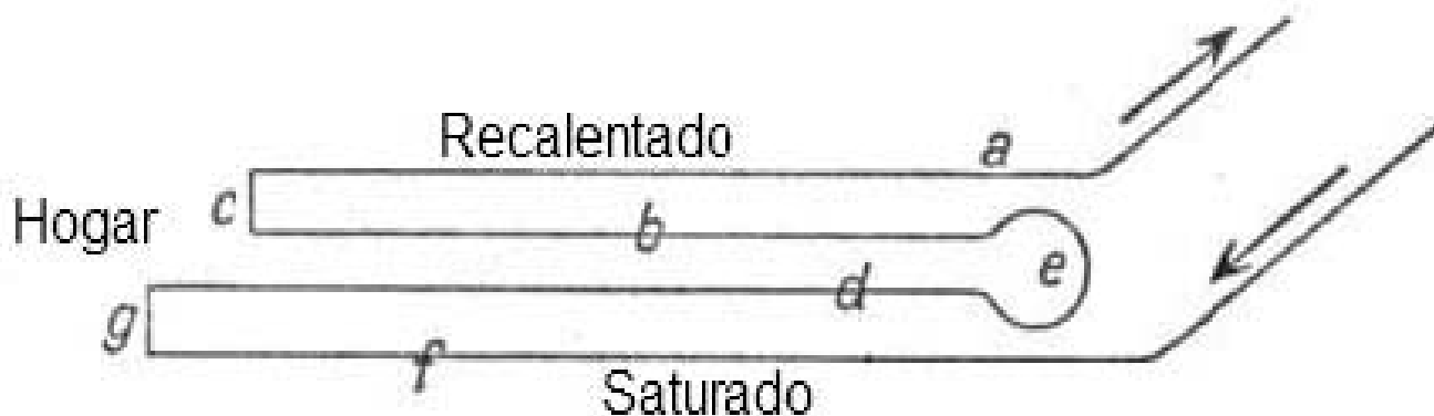
Fig. 221 – Esquema de un elemento recalentador: f: 1º tramo; g: 1º codo; d: 2º tramo; e: bucle exterior; b: 3º tramo; c: 2º codo; a: 4º tramo
