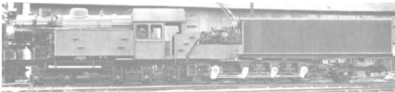
Fig. 122 - Locomotora argentina a turbina. Ésta estaba montada en el frente del tender de condensación, accionando el primer eje acoplado a través de una reducción múltiple de engranajes.
