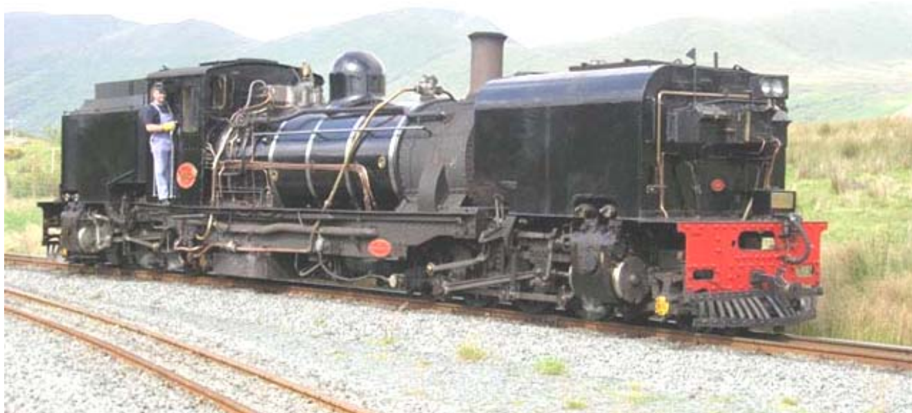
Fig. 88 - Locomotora Garratt de los Ferrocarriles Sudafricanos, trocha 2' (610 mm), N° SAR NGG 16, preservada en condiciones de operación en el Ferrocarril Welsh Highland (Gales)
