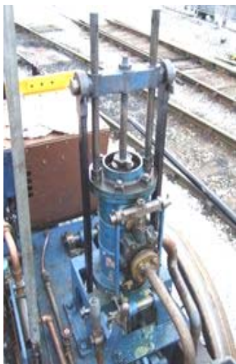
Fig. 35 - Cilindros de la réplica de la Novelty
