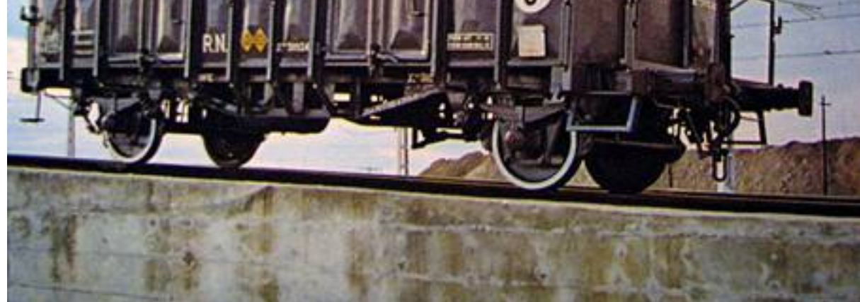
Foto de fábrica del Xfv 389 565, construido por Vers en 1962 con paredes metálicas, con la primera numeración UIC (21 71) y serie Elo (cajas Athermos limitadas a 80 km/h) manteniendo las letras R.N. Presenta bandajes perfilados en blanco, muy típicos de muchos vagones unificados en sus repintados. (Doc. Renfe).
