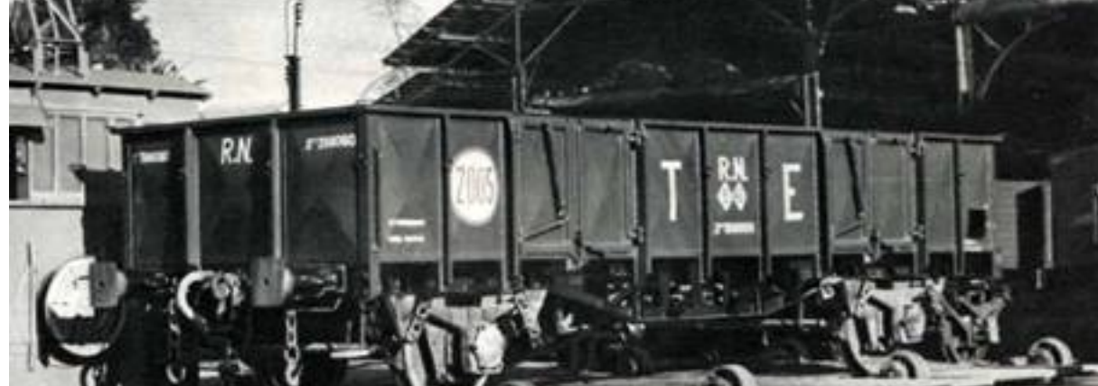
Xfhv 385.603, del primer lote construido con freno de mano en balconcillo por Eskalduna en 1953. La foto presenta su aspecto cuando fue repintado en rojo en los 60 con la primera numeración UIC 21 71. En los unificados largos de Renfe, sólo los vagones con balconcillo y freno de mano contaban con soportes para faroles y señales, ya que con las normativas de Renfe los que carecían de este freno no podían ser ubicados en cola de tren. (Doc. Renfe).
