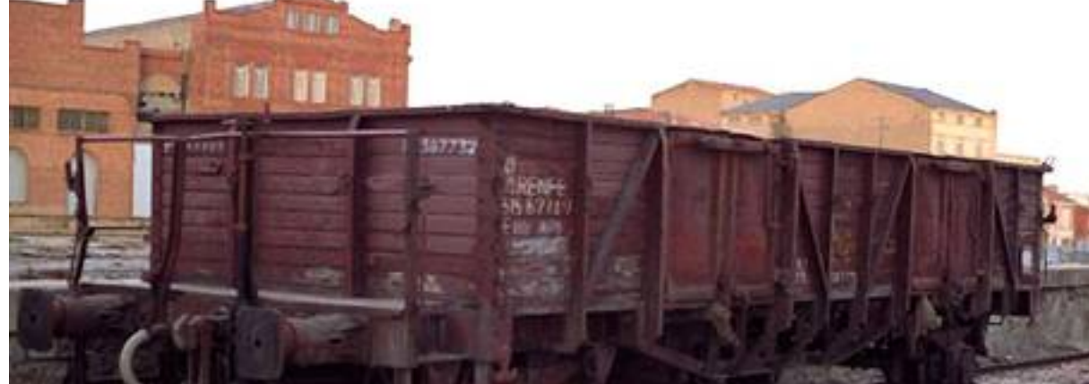
Muchos vagones de la serie mantendrían el gris incluso en los años setenta. A destacar el remate rojo de los tornillos de cierre de las cajas de grasa. (Doc. Renfe)
