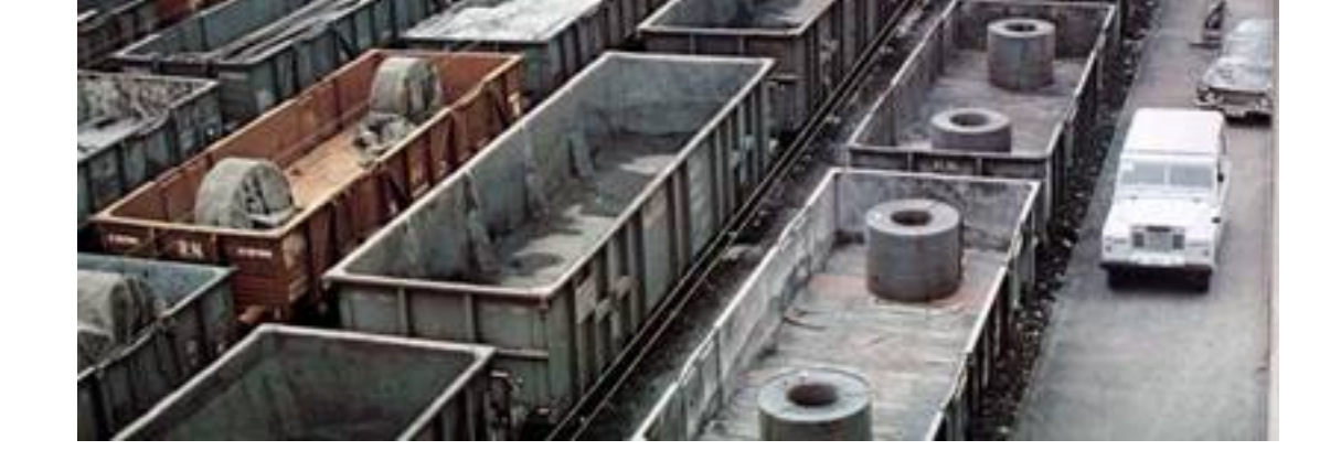
Interesante imagen del metálico Xfv 389 618, construido por Los Certales en 1961, con la primera numeración sin serie UIC y color gris. (Doc. Renfe).
