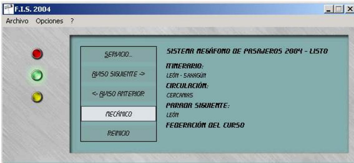
Como se observa en la imagen, debemos tener la luz verde encendida, lo que indica que el sistema esta listo para funcionar.
